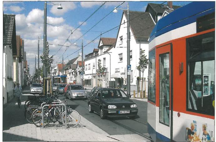
Haltestelle Fuchsstraße, nach dem neuen Mischverkehrsprinzip angelegt: Fahrgastwechsel sicher und barrierefrei am Gehweg, der verbliebene innerörtliche Autoverkehr ist der Straßenbahn nachgeordnet.
