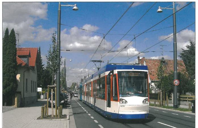
Fast an gleicher Stelle heute: Die Bahn hat soeben die Haltestelle Fuchsstraße verlassen und fährt nach wenigen Metern in den eigenen Bahnkörper Richtung Zentrum ein; Alleeebäume, breite Gehwege, Fahrradstreifen und Kombimasten, die Fahrleitung und Beleuchtungskörper tragen – es gilt „Tempo 40“ für alle.
