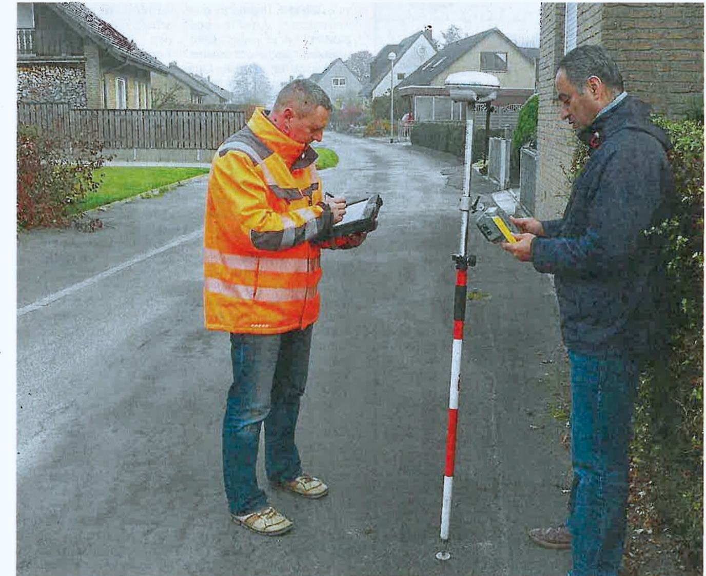
Arne Donak (links) und sein Kollege Raid Naamnih können mit dem GPS-Gerät ihren Standort millimetergenau be- stimmen. Die Vermessung ist Grundlage für die spätere Ausbauplanung.
